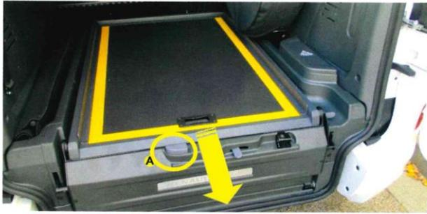
1 Appuyer sur le bouton poussoir **A**, afin de déverrouiller la rampe (bouton poussoir en position basse).
