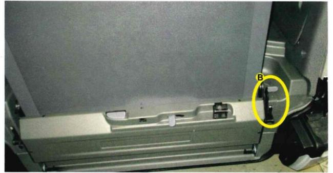
Tirer sur la poignée d'ouverture de la rampe **B**, puis accompagner la rampe dans sa descente jusqu'au sol, en évitant de la lâcher.
