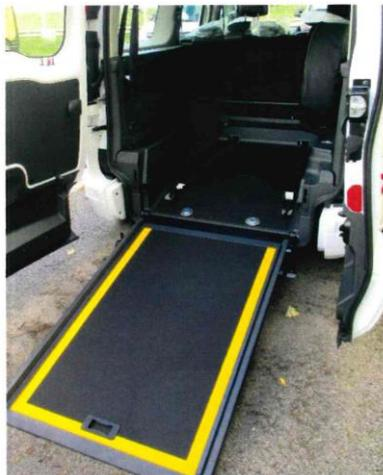
Lever puis pousser jusqu'au verrouillage de la rampe en position verticale.
